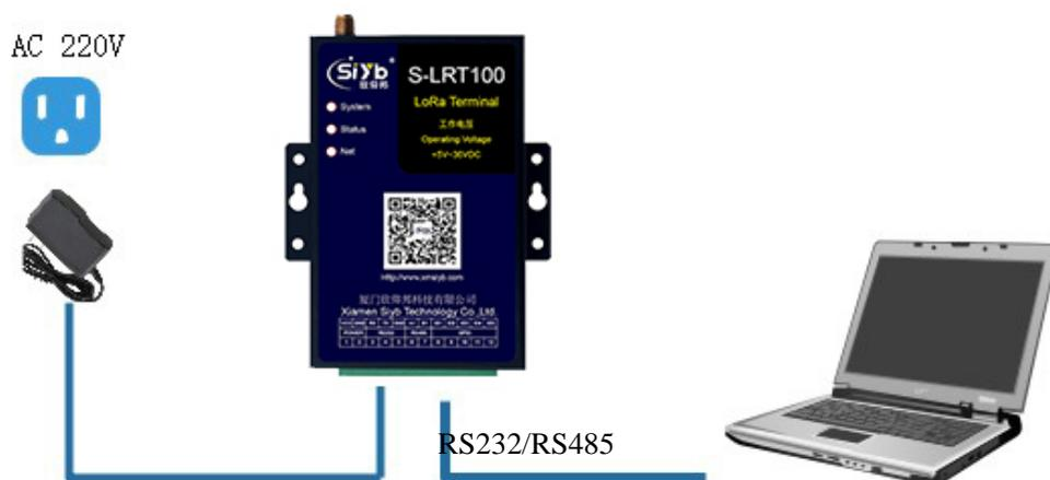
图 3-1 S-LRT100 与 PC 的配置连接
