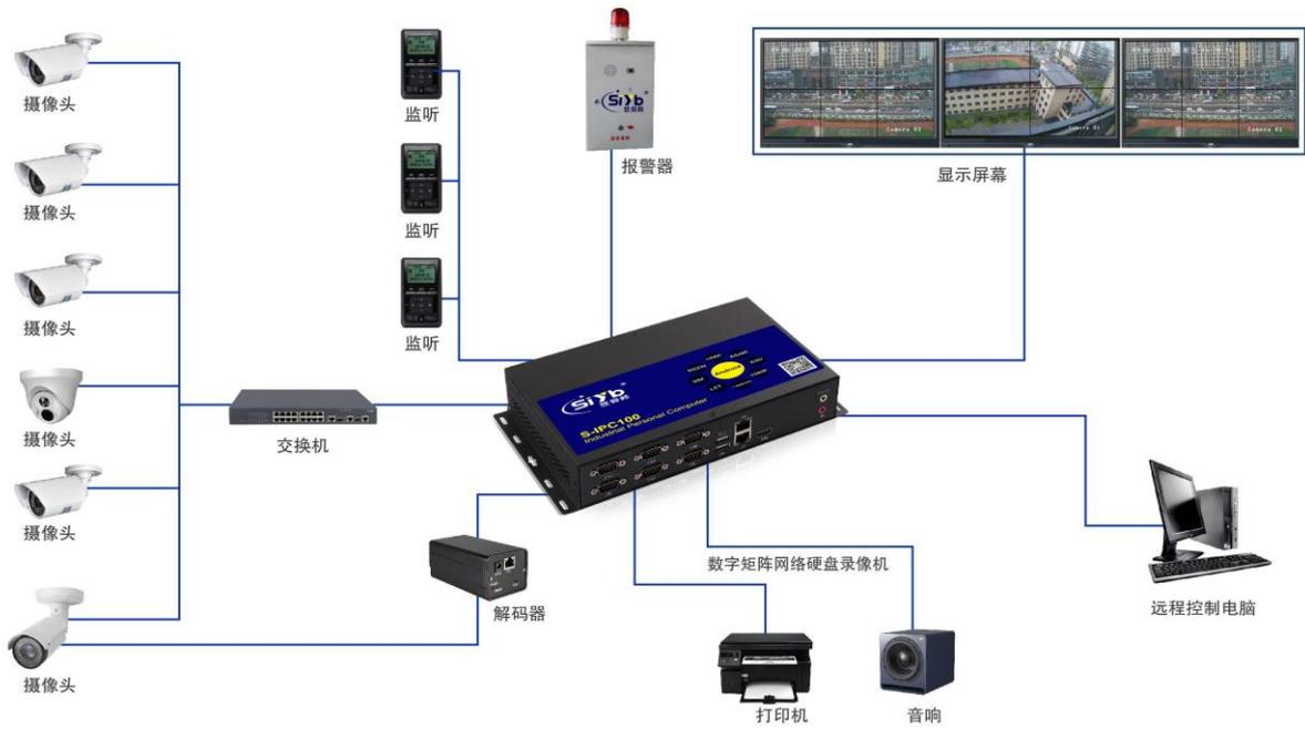
图 25 视频监控系统组件连接图
